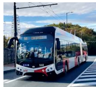
Bateriový trolejbus ujezdí na energii z akumulátorů vzdálenost až 12 kilometrů mimo trakční vedení. Ilustraci foto: DPP/Ondřej Kubát
